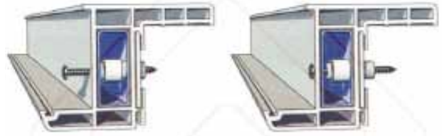
شکل ۱۱ جزئیات قرارگیری مهروه تثبیت کننده در پروفیل
