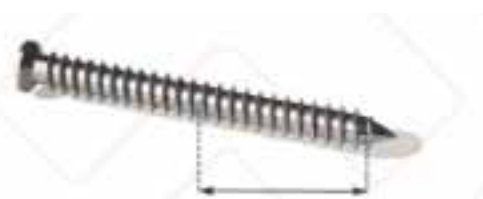
شکل ۱۹ نمونه پیچ بدون نیاز به رول پلاگ برای درگیری حداقل ۴۰ میلی متر در داخل بتن
