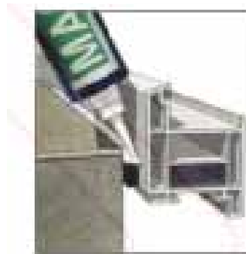
شکل ۸ کاربرد ته بند درز (اسفنج آغشته) برای تنظیم ابعاد بتانه تزریقی
