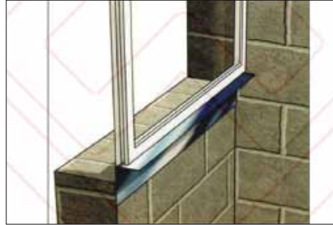
شکل ۴۳ طول ورق نبشی سراسر حداقل برابر با عرض خالص پنجره
